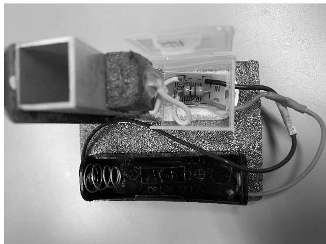
図5 LED ICドライバーと電池ケースとLEDの接続
